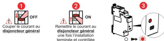
. 3/ Appuyer plus de 3 secondes sur le bouton de configuration du Module Control, OU au centre de la commande générale sans-fil Départ/Arrivée jusqu'à ce que le voyant s'allume brièvement en vert, puis relâcher l'appui.
