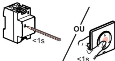
Appuyer brièvement sur le bouton de configuration du module Control (ou au centre de la commande générale sans-fil Départ/Arrivée) pour finaliser l'installation.
